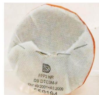
Fig. 33 : Encrassement du masque anti-poussières FFP2 après utilisation
